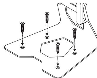
Usare le viti in dotazione per fissare la base del supporto a una superficie in legno.
