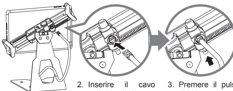
2. Inserire il cavo nello slot di sicurezza del frame.
