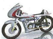
Quali genera energia rotante che viene trasportata alla ruota posteriore, tramite la catena. La moto del Rmit dovrebbe toccare la velocità dei 180 km all'ora, ma è ancora un prototipo e il motore non è stato ultimato.
