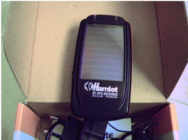
Grazie alla collaborazione di Hamlet abbiamo potuto provare il Solar GPS, interessante ricevitore GPS Bluetooth alimentato grazie all'energia solare che funge da supporto alla batteria ricaricabile in dotazione.
