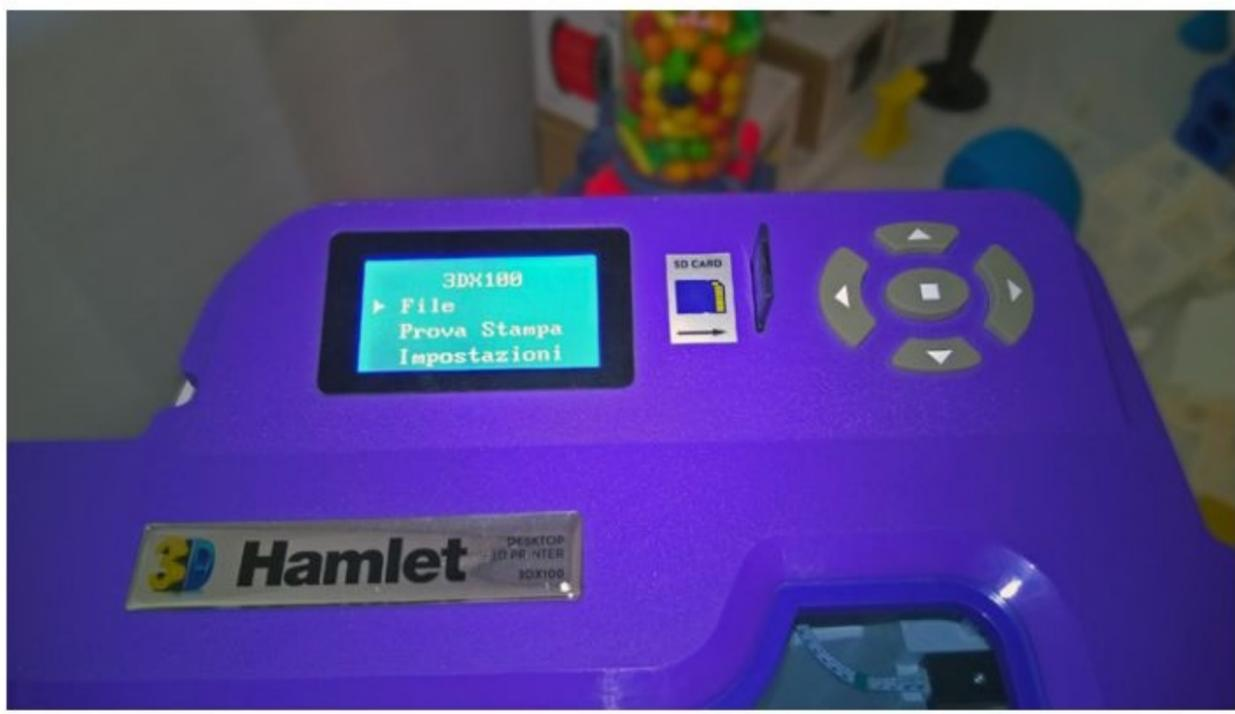
Il funzionamento tramite memorie esterne e pannello di controllo rende la 3DX100 adatta anche per l'esecuzione di attività PC-less, in modalità stand-alone. In questo modo, i sistemi di stampa 3D sono giunti a un passo dalla commercializzazione di massa e possono essere utilizzati da designer, architetti, PMI e scuole, il tutto a un costo contenuto.
