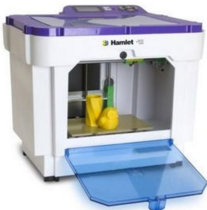
Il principio di funzionamento si basa sulla deposizione a caldo del materiale mediante estrusione su una base riscaldata con una precisione di 0,15 millimetri. Il file con il progetto da stampare in formato GCODE-STL può essere inviato tramite porta USB oppure memorizzato su una normale scheda SD e inserito nell'apposito lettore posto di fianco al display LCD.
