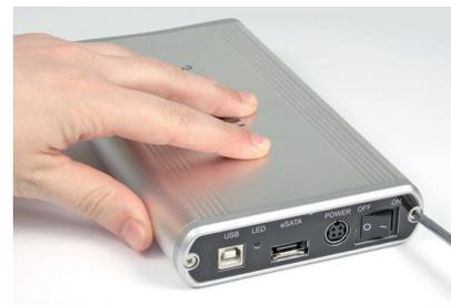
1. Svitare le 2 viti di fissaggio per rimuovere il pannello posteriore.
